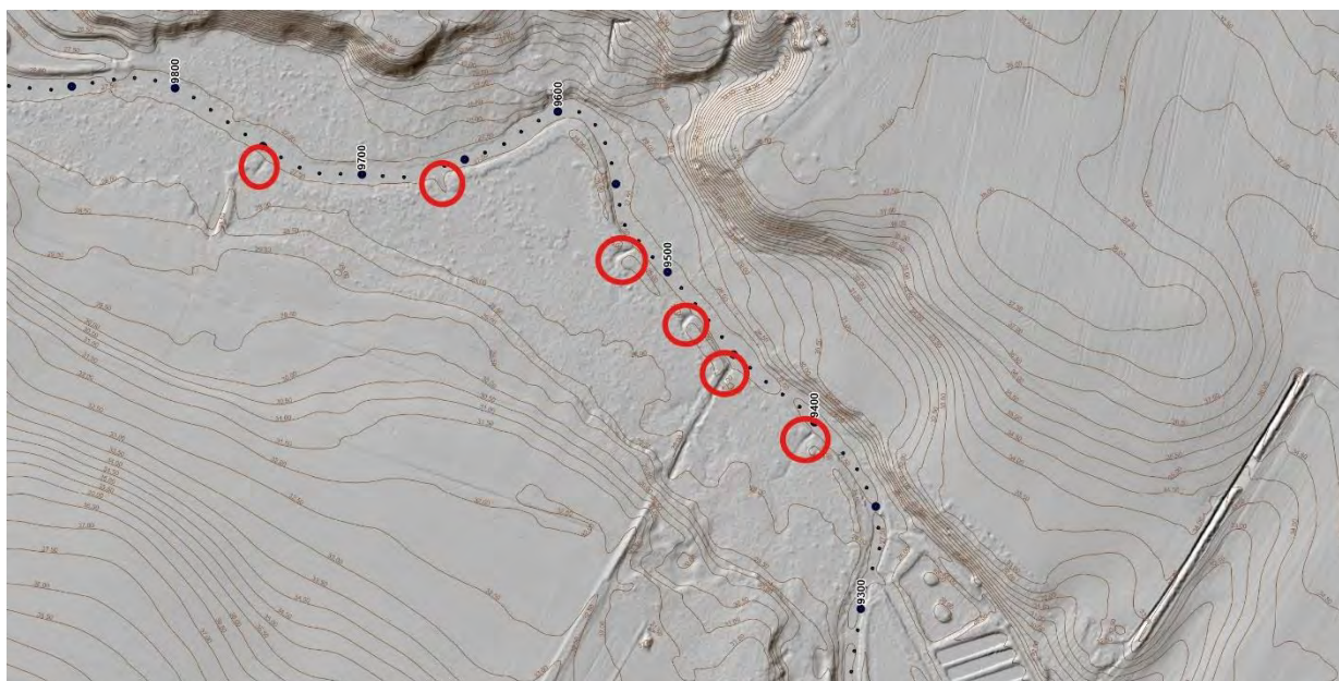
Figur 10 Projekttiltag på strækning 1 i aske-ellesumpen, der er lokaliseret i stuvningszonen opstrøms vandindtaget til Hulkær Fiskeri. Vandførende lavninger i terrænet, hvor udstrømmende trykvand fra sumpområderne er observeret, fyldes med grus tærskler til kote 27,35 m DVR90
